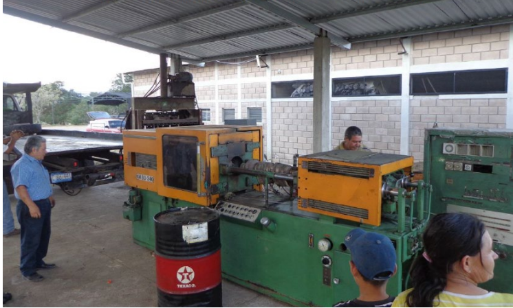
Imagen de la maquina inyectora de plástico, cuando fue colocada planta en el sitio del Motolin
