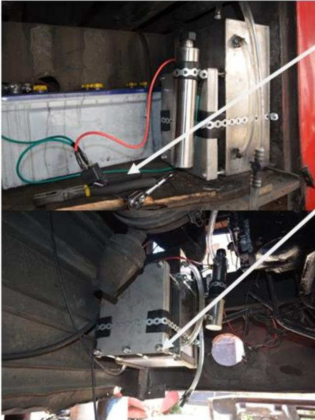
Instalación de relé a batería y celda de HHO.
