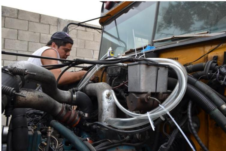
Mangueras de inyección gas de HHO, conectadas en el sistema de admisión del motor Diésel.
