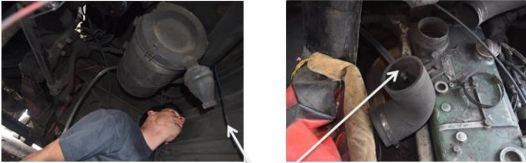
Conexión de manguera de inyección de gas de HHO en el filtro de aire en unidad transporte.
