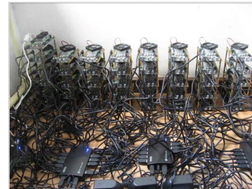
Minero Bitcoin construido a partir de (muchas) tarjetas de video
