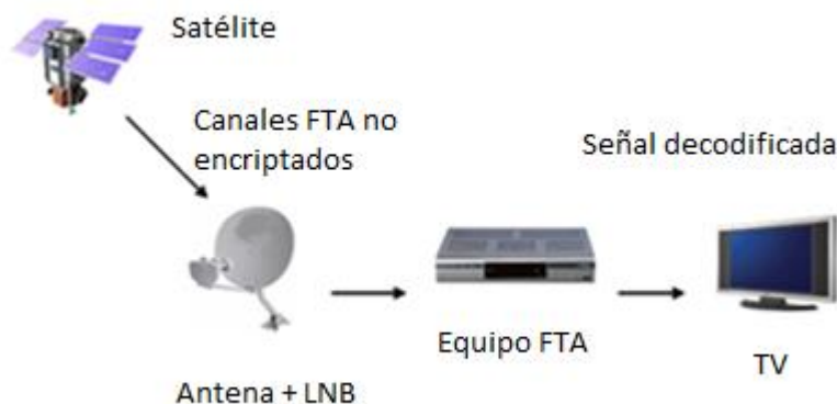
Figura 2: Funcionamiento de un equipo FTA
