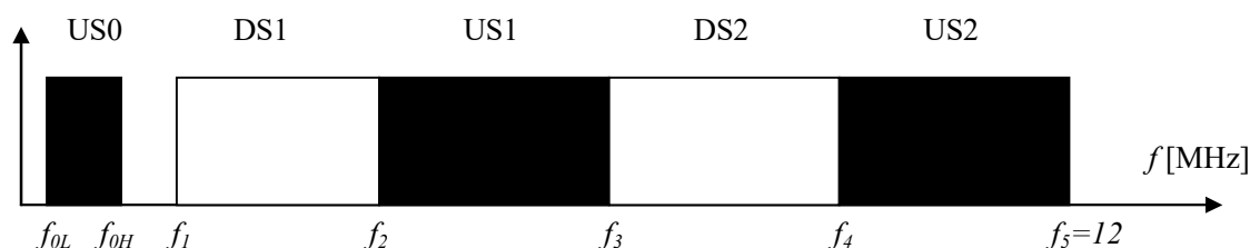
Figura 7-1/G.993.2 – Plan de bandas en la gama de frecuencias por debajo de 12 MHz
