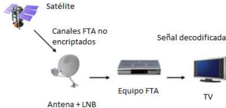
Figura 2: Funcionamiento de un equipo FTA
