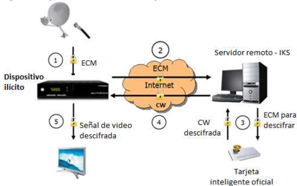
Figura 3: Arquitectura de un sistema IKS para cometer fraude
