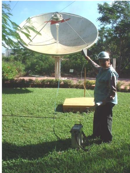
Se utiliza un analizador de espectros y una antena tipo corneta que operen en el rango de frecuencias de interés, que para este tipo de verificaciones, sería la frecuencia de transmisión al satélite en la banda de operación correspondiente.
