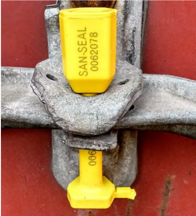
Sello de contenedor. Fuente: https://rficarqo.com/precinto-contenedor/
