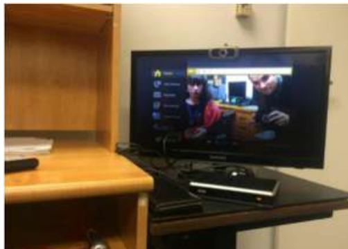
Imagen del Video-teléfono, compuesto por un televisor, una caja con el software, y una cámara web, más los cables. Eso se conecta al internet regular, por cable. Se visualiza un menú del software del equipo: historia de llamadas, mensajes en lengua de señas, directorio telefónico, etc.
